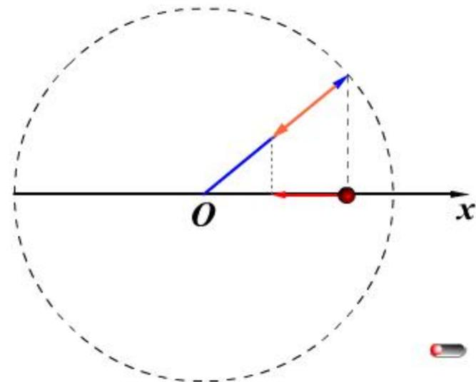
简谐振动物体的加速度
